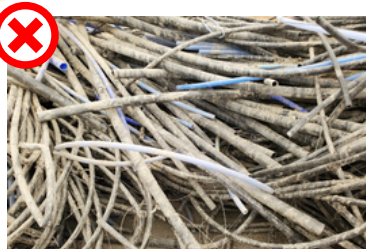
Tubulures sales ou pleines de terre
